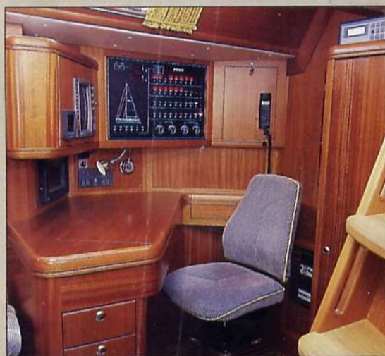
Il carteggio, il cui piano misura cm 140x58, presenta una lunga consolle per gli strumenti e una poltrona girevole. A destra, la cucina ricavata nel corridoio verso poppa.
