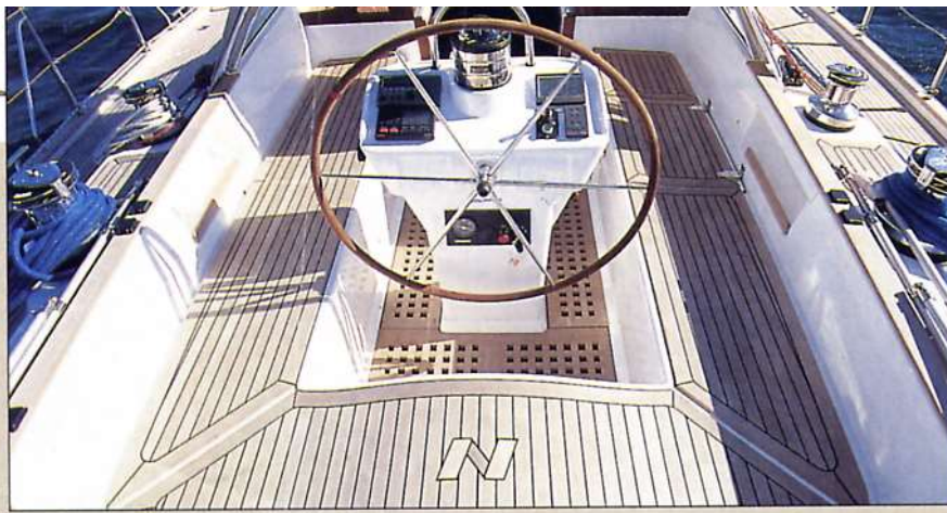
Ben protetto dal vetro fisso e dal dodger in tela, entrambi forniti di serie, il pozzetto ha dimensioni tutt'altro che nordiche: è lungo 250 cm e largo 204.
