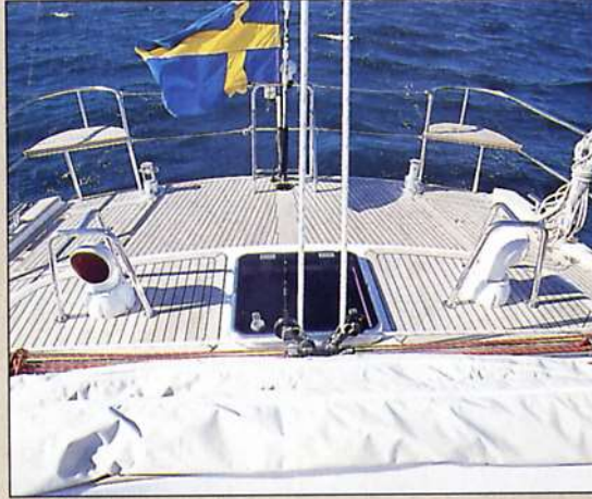
Sopra, il tambuccio con i piani di appoggio laterali protetti dal paraspruzzi; a destra, l'ampia zona a poppavia del pozzetto, fruibile come prendisole.
